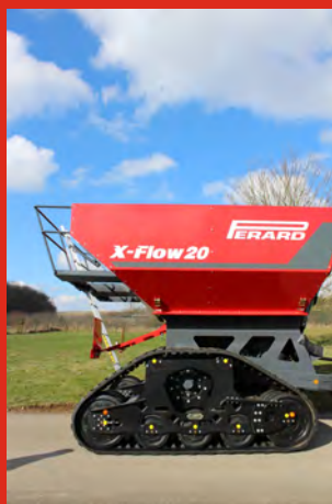
Разгрузочный шнек Ø600 мм, это выгрузка 20 м 3 за 50 секунд *!
