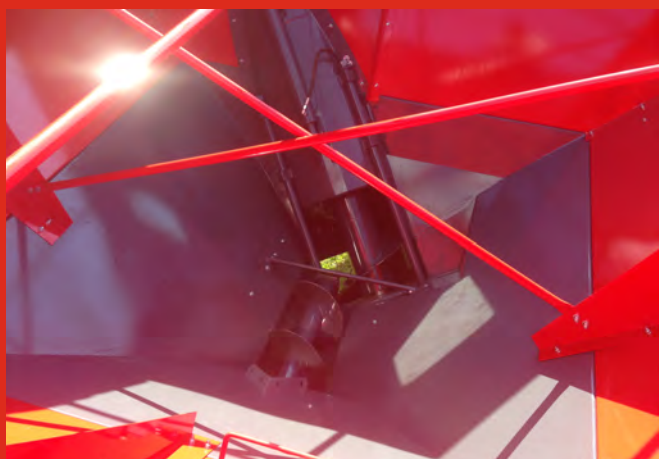
Разгрузочный шнек Ø600 мм, это выгрузка 20 м 3 за 50 секунд *!
